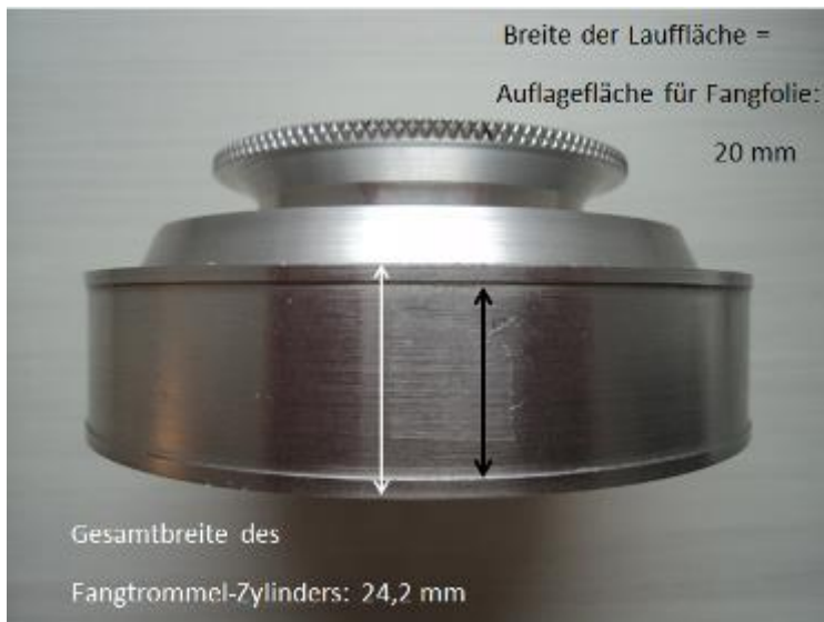
Bild 2. Fangtrommel (von BURKARD Manufacturing als Beispiel) mit Blick auf die Lauffläche (ohne Fangfolie).
