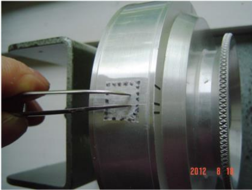
Bild 6. Fangtrommel mit aufgezogener MELINEX®folie: Mit der Pinzette ist hier der (nicht verklebte) Überlappungsbereich angedeutet.
